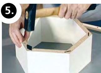
Fixo E20-H - Self clamping biscuit
