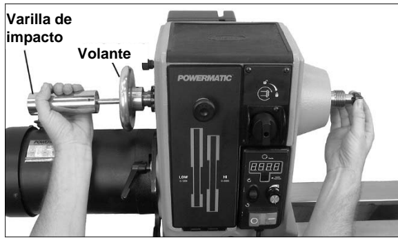
Figura 8-5: retirada de centros
